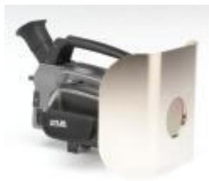
GF309 は、高温(最高1500°C)の炉検やボイラー検査のために特別に「炎フィルター」を備えています。このニッケルコーティングの熱シールドによって、作業者は安全にかつ熱を感じずに検査をすることが可能になります。
